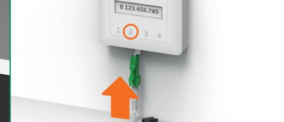
Nur ein Steckplatz funktioniert: Nehmen Sie die Schutzkappe ab. Öffnen Sie bei der Glasfasersteckdose den vorgegebenen Steckplatz (in der Regel «2», selten «1»). Achtung: Falls Ihre Anschlüsse gegen oben montiert sind, ist Steckplatz 2 der zweite von rechts. Zum Entfernen des Kabels siehe Rückseite. 1
