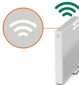
Per attivare e disattivare la sua WLAN, prema il tasto . Per saperne di più sulla sua WLAN e i suoi dati di accesso (nome WLAN e password), veda sul retro di queste istruzioni. **4**
