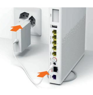
Schliessen Sie das DSL-Kabel mit dem weissen Adapter an.
