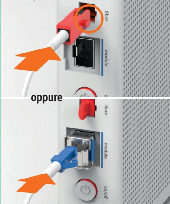
Usi il nuovo cavo in fibra ottica. Tolga i cappucci di protezione e colleghi l'estremità rossa o blu del cavo in fibra ottica all'Internet-Box. Non tocchi le estremità del cavo. Porta per fibra ottica blu: è fondamentale collegare il dispositivo di sicurezza del modulo in modo che il cavo sia ben saldo.
