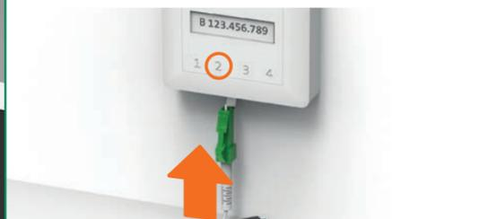
Funziona in un solo slot: toglia il cappuccio di protezione. Sulla presa in fibra ottica, apra lo slot predefinito (in generale il «2», raramente l'«1»). Importante: se le porte sono posizionate in alto, lo slot 2 è il secondo da destra. Per rimuovere il cavo, veda retro. **1**
