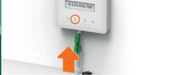
Nur ein Steckplatz funktioniert: Nehmen Sie die Schutzkappe ab. Öffnen Sie bei der Glasfasersteckdose den vorgegebenen Steckplatz (in der Regel «2», selten «1»). Achtung: Falls Ihre Anschlüsse gegen oben montiert sind, ist Steckplatz 2 der zweite von rechts. Zum Entfernen des Kabels siehe Rückseite. **1**
