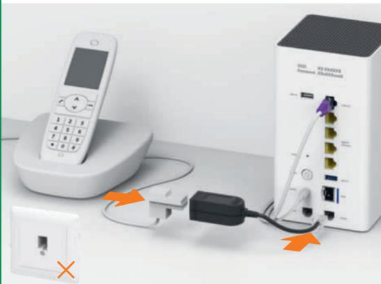
Verbinden Sie analoge Telefone und DECT Basisstationen mit «phone».
