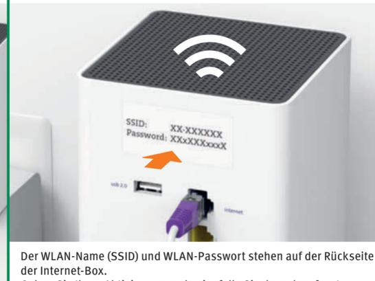
Der WLAN-Name (SSID) und WLAN-Passwort stehen auf der Rückseite der Internet-Box. Geben Sie Ihren Aktivierungscode ein, falls Sie danach gefragt werden.
