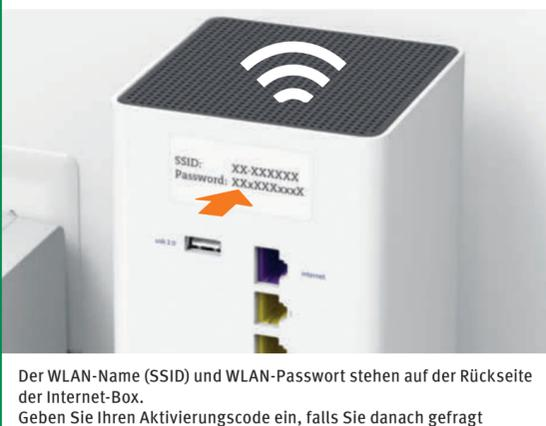
Der WLAN-Name (SSID) und WLAN-Passwort stehen auf der Rückseite der Internet-Box. Geben Sie Ihren Aktivierungscode ein, falls Sie danach gefragt werden.
