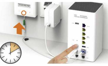
Verwenden Sie bei der Glasfasersteckdose wie im SMS angegeben den Steckplatz 2. Das stimmt in den meisten Fällen – in seltenen Fällen ist es der Steckplatz 1.
