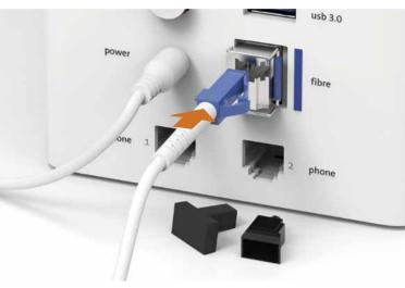
Zuerst müssen Sie vorsichtig die schwarzen Schutzkappen, sowie die Schutzkappe, die sich beim Anschluss «fibre» befindet entfernen.
