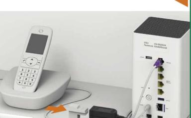
Verbinden Sie analoge Telefone und DECT Basisstationen mit «phone».
