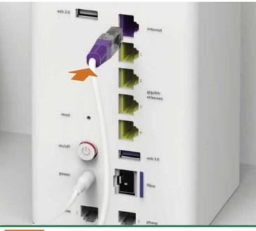
Sie verbinden das Kabel mit der Telefonsteckdose, schalten die Internet-Box ein und warten 10 Minuten:
