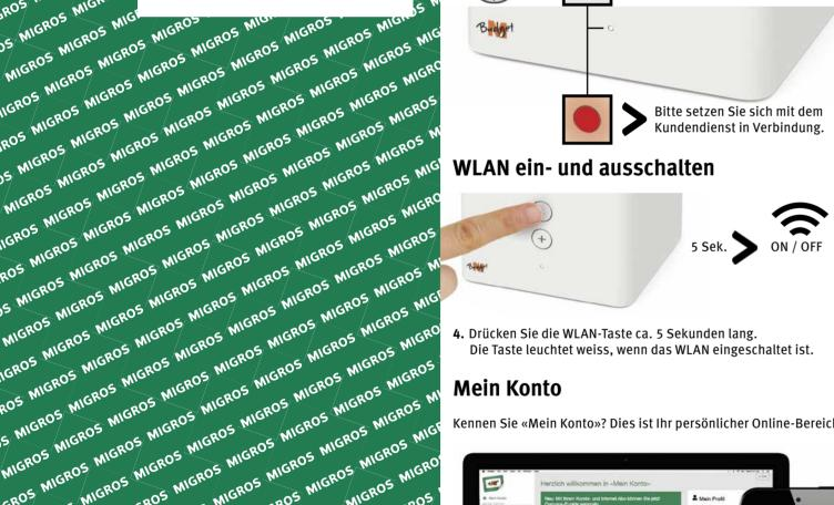
4. Drücken Sie die WLAN-Taste ca. 5 Sekunden lang. Die Taste leuchtet weiss, wenn das WLAN eingeschaltet ist.
