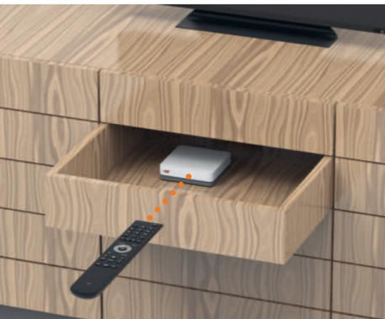
La télécommande et la TV-Box sont reliées entre elles par bluetooth. Les deux appareils ne nécessitent pas de contact visuel. Mais ne placez pas la TV-Box derrière une paroi/porte métallique. La TV-Box doit être bien ventilée afin d'éviter la surchauffe et les dommages.
