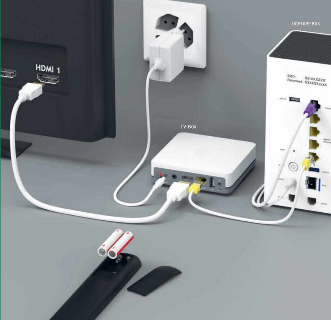
**4** Schliessen Sie die Internet-Box mit dem mitgelieferten Ethernet-Kabel an die TV-Box an.
