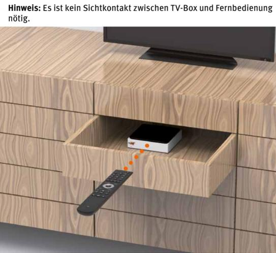
Die Verbindung zwischen Fernbedienung und TV-Box läuft über Bluetooth. Die beiden Geräte benötigen keine Sichtverbindung. Stellen Sie die TV-Box aber nicht hinter eine Metallwand /-tür.
