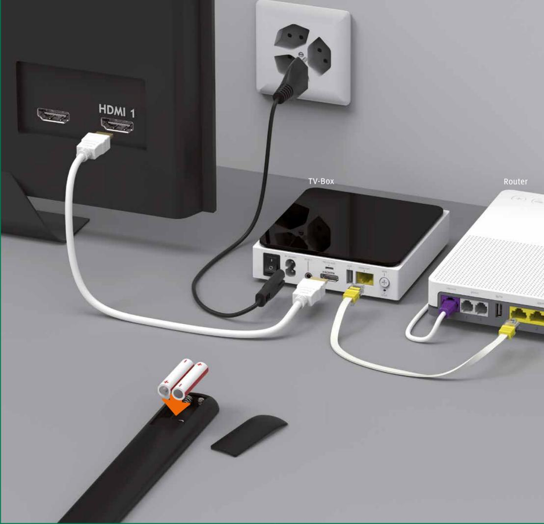
**4** Schliessen Sie den Router mit dem mitgelieferten Ethernet-Kabel an die TV-Box an.
