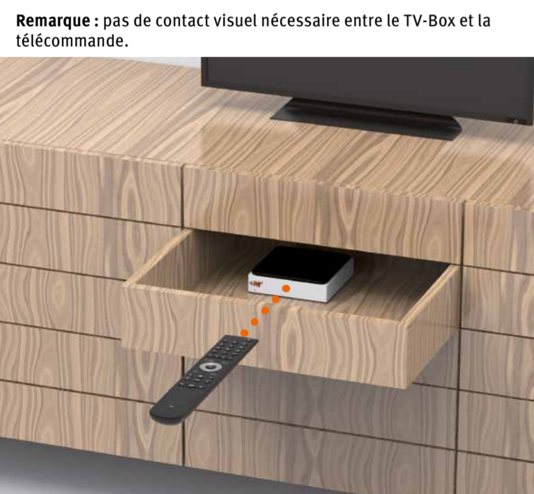
La télécommande et la TV-Box sont reliées entre elles par bluetooth. Les deux appareils ne nécessitent pas de contact visuel. Mais ne placez pas la TV-Box derrière une paroi/porte métallique.
