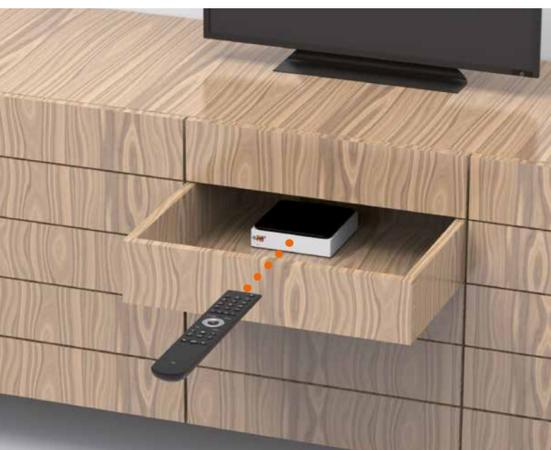
La connessione tra il telecomando e la TV-Box avviene tramite Bluetooth. I due apparecchi non richiedono alcun contatto visivo. Tuttavia, non mettere la TV-Box dietro una parete/una porta di metallo.
