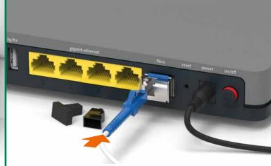
Zuerst müssen Sie vorsichtig die schwarzen Schutzkappen, sowie die Schutzkappe, die sich beim Anschluss "fibre" befindet entfernen. Schliessen Sie anschliessend die blaue Seite des Kabels an Ihren
